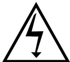
Символ молнии со стрелкой внутри равностороннего треугольника предназначен для предупреждения пользователя о наличии неизолированного «опасного напряжения» внутри корпуса изделия, величина которого может быть достаточной, чтобы представлять опасность поражения человека электрическим током.
